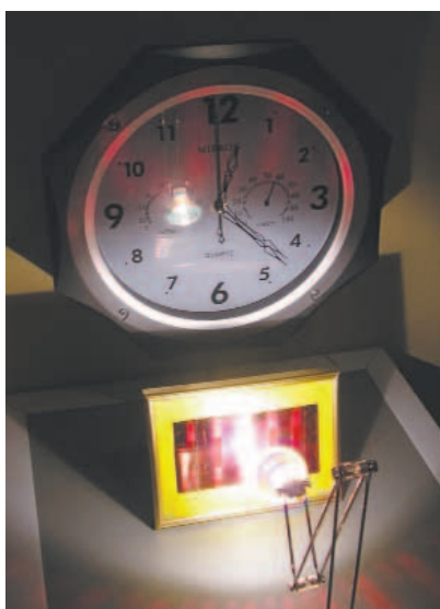
Демонстрационный лабораторный образец органической солнечной батареи, разработанный в ИПХФ РАН, которая приводит в действие настенные часы
